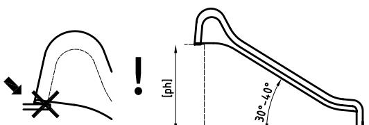
**3** rutschenauslauf am montagebügel montieren → der Bereich über dem fundament sollte nach 2 bis 4 tagen mit einem für diesen zweck geeigneten material aufgefüllt werden
